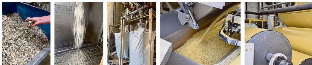
Angelieferte PVC-Schnitzel mit Metallteilen werden aussortiert, der Rest wird zermahlen und in Säcke abgefüllt. Das recycelte Material kann zu Bodenbelägen verarbeitet werden.
