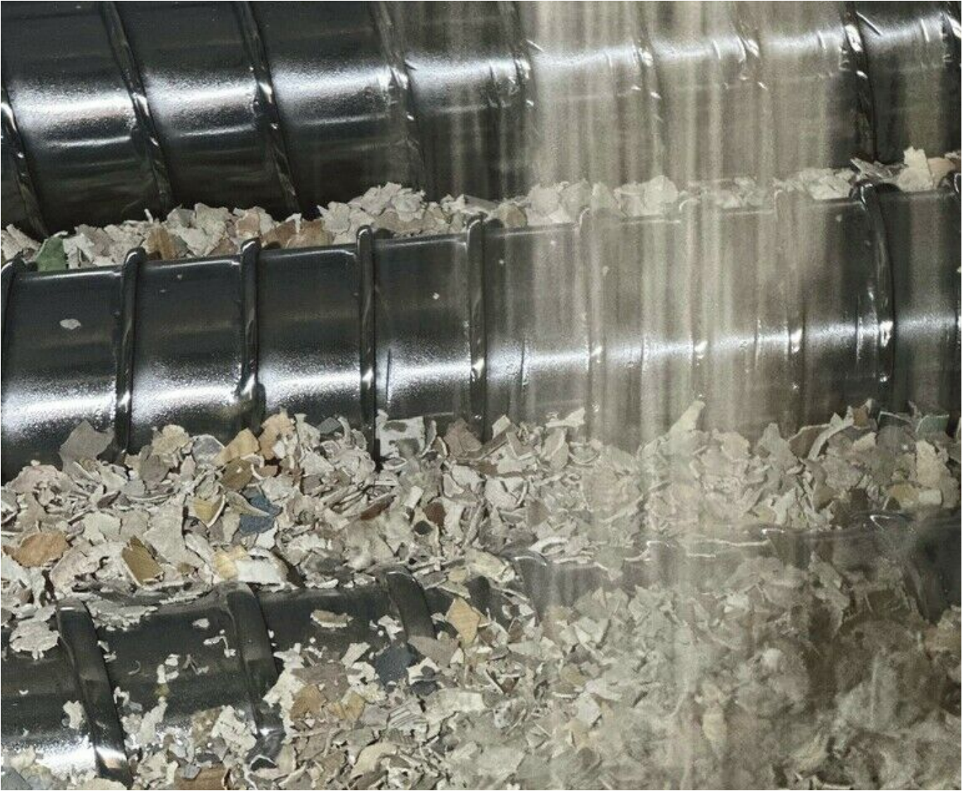
Mechanische Zerkleinerung von Altbelägen
